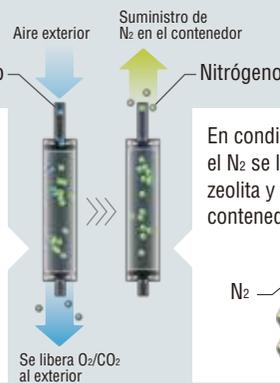
En condiciones de vacío, el N<sub>2</sub> se libera de la zeolita y se carga en el contenedor
